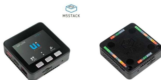
Rysunek 1: M5stack - podstawowy rdzeń ESP32
